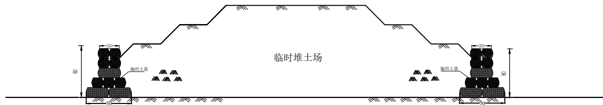
临时堆土场临时挡护断面示意图
