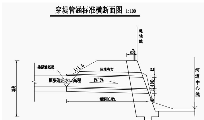
图 2.1-5 穿堤管涵断面示意图
