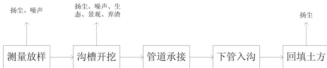
图 5-2管道工程工艺流程及产污环节图
