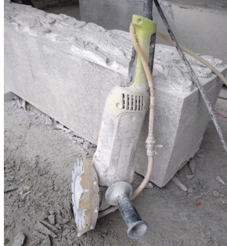
人工修边、取型、打磨生产车间（三面封闭、角磨机设有喷水设施）
