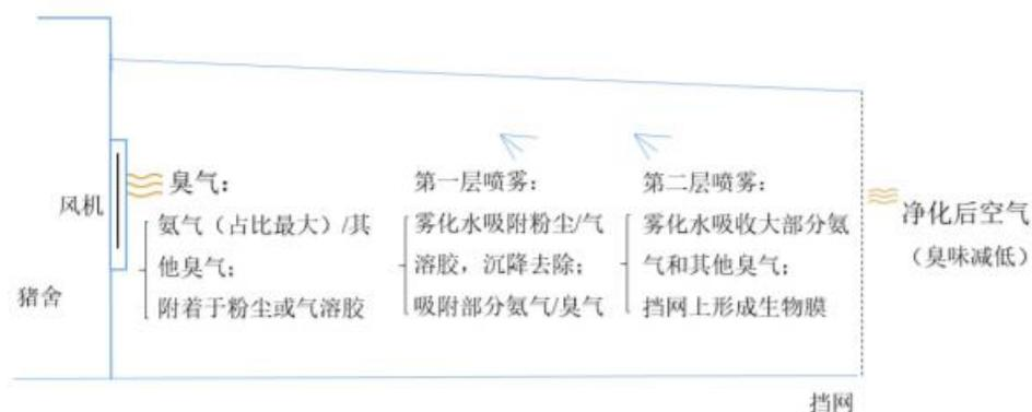
图 3-9 猪舍除臭装置示意图
