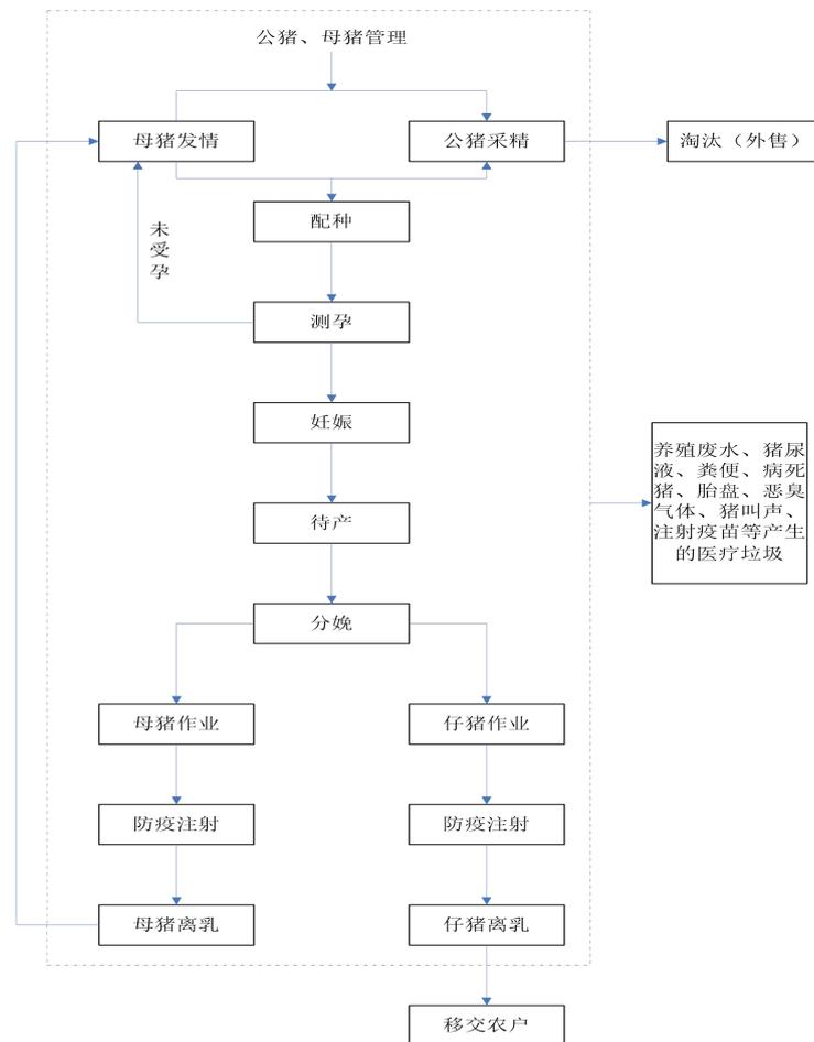
图 3-2 项目养殖工艺流程及产污位置图
