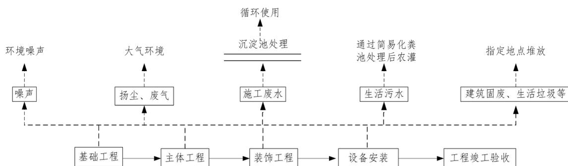
图 3-1 施工期工艺流程及产污环节图
