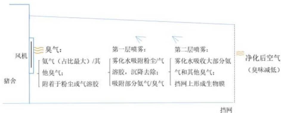
图 6-2 猪舍除臭装置示意图
