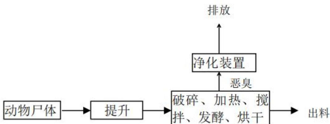
图 3-6 动物尸体无害化降解处理工艺流程图
