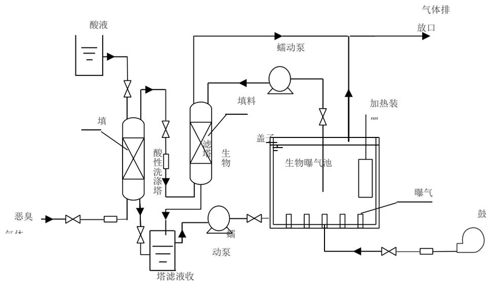
图 6-3 恶臭气体处理工艺流程图
