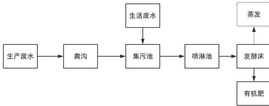
图 5-1 废水处理工艺流程图
