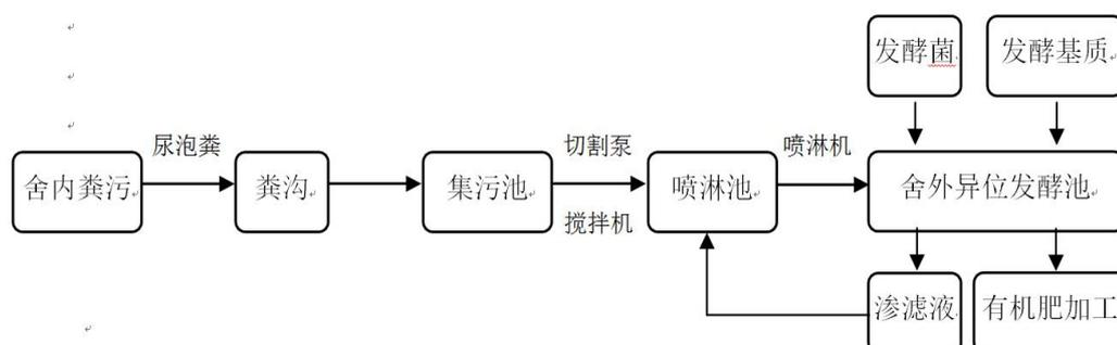
图 6 生产废水和粪便处理工艺流程图
