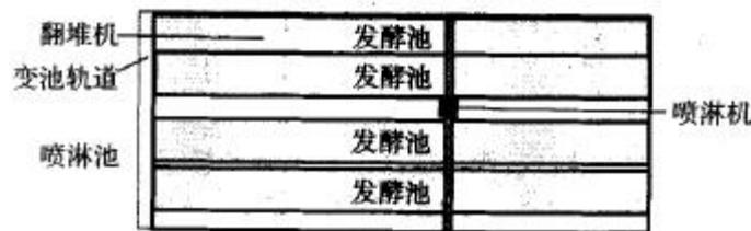
图 6-1 异位发酵床建设示意图
